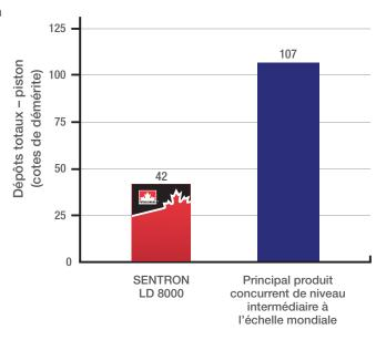
Dans un essai sur moteur à gaz naturel Caterpillar G3500TALE, l'huile SENTRON LD 8000 a duré jusqu'à 8 000 heures dans une application de compression de gaz naturel avec du gaz de pipeline, dans des conditions de charges élevées (>90 %).
